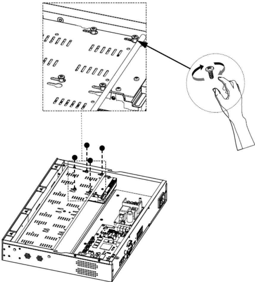
6. Při plném obsazení HDD zajistěte všech 16 šroubků na HDD držáku a utáhněte šroubovákem.
