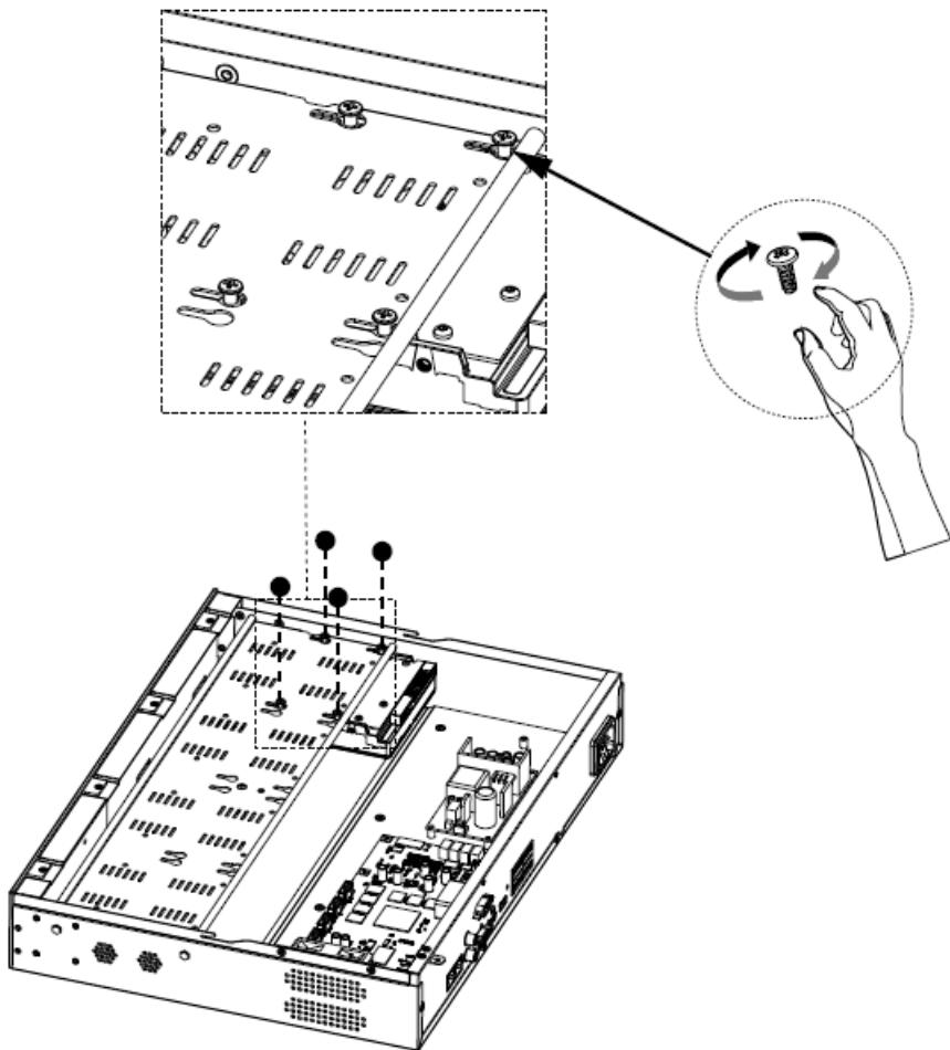
13. Pri plnom obsadení HDD zaistite všetkých 16 skrutiek na HDD držiaku a utiahnite skrutkováčom.
